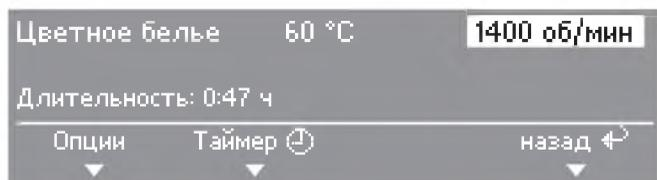
Вращением мультифункционального селектора можно выбрать различные компоненты программ, программу, температуру, скорость отжима. Выбранный компонент выделяется. При нажатии мультифункционального селектора компонент выбирается, и открывается соответствующее подменю.
