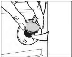
Закройте отверстия стопорами и закрепленными на них заглушками.
