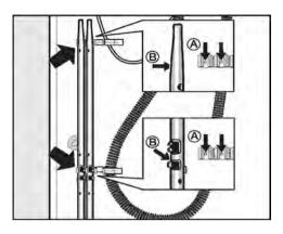
■ Закрепите транспортировочные стержни на задней стенке стиральной машины. Проследите за тем, чтобы отверстия ® попали на цапфы A.
