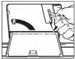
Потяните вниз устройство аварийного открывания, например, с помощью ручки ложки. Дверца откроется.
