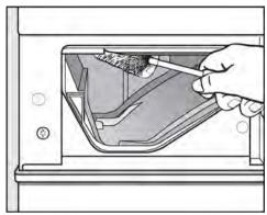
■ С помощью ершика для мытья бутылок удалите остатки моющих средств и отложения извести с форсунок подачи воды в отсеке для моющих средств.
