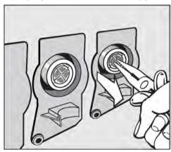
■ Вытащите фильтр наружу, захватив его пинцетом за стенку, почистите и установите фильтр на место, действуя в обратной последовательности.
