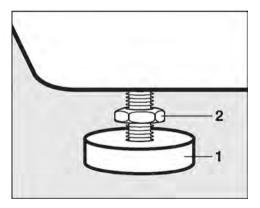
■ Отверните контргайку **2** с помощью прилагаемого гаечного ключа по часовой стрелке. Выверните контргайку **2** вместе с ножкой **1**.
