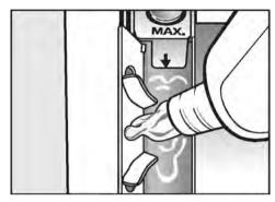
Заполните ополаскивателем, добавкой для придания формы или жидким крахмалом ячейку ⊗.
